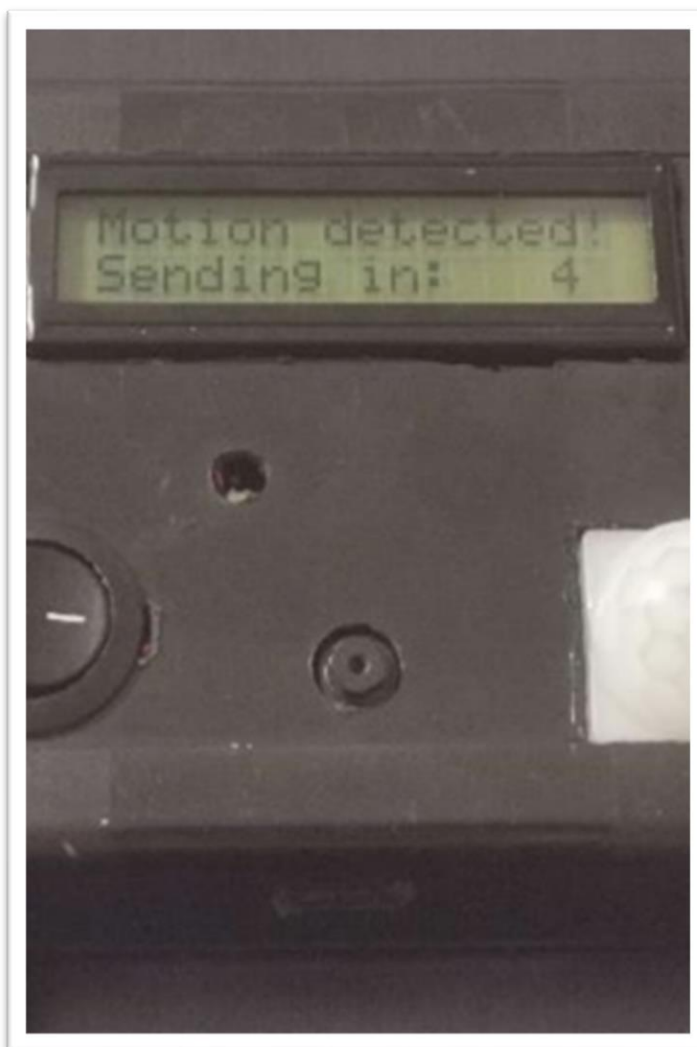
4. ábra Saját fejlesztésű biztonsági eszköz, kamerával, mozgásérzékelővel
